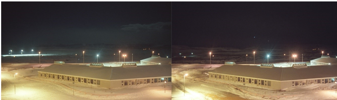
Mynd 3a og 3b. Hvaleyrarskóli í Hafnarfirði. Óumbeðin birta, glýja og oflýsing sbr IDA. Ljósmynd SG.
